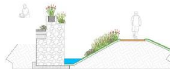
Kanāls ar gabiona atbalsta sienu
