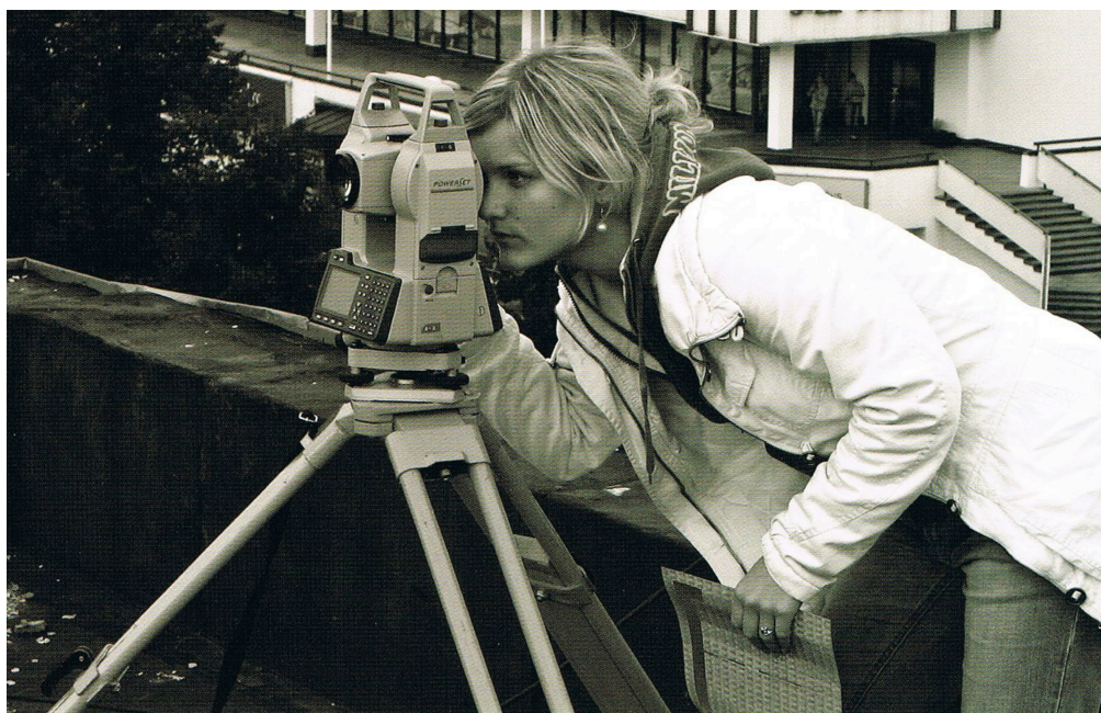
24. attēls. Lauka uzmērījumu veikšana, izmantojot kodu tabulu (Foto: M. Reiniks)
